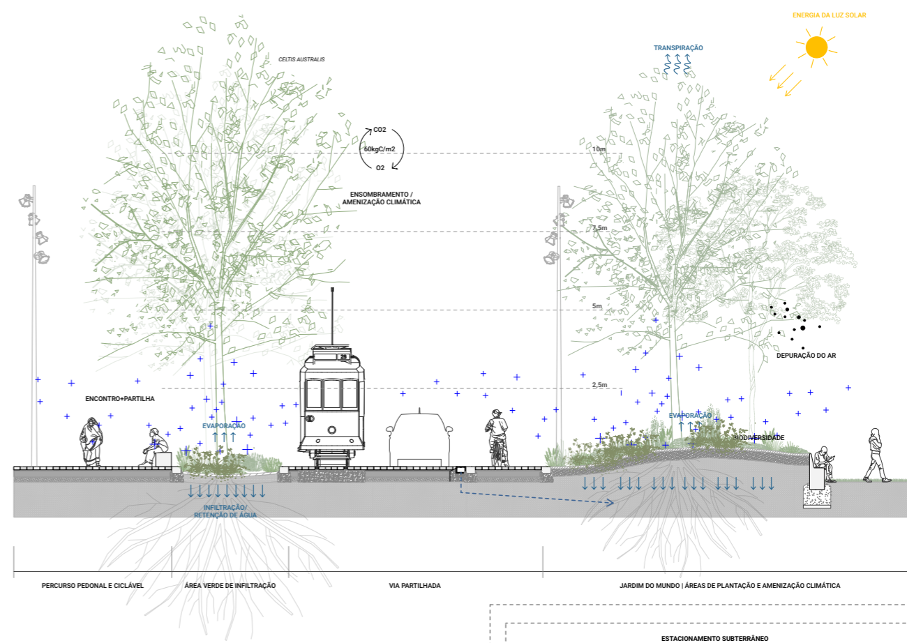
PERFIL DA VIA PARTILHADA E DRENAGEM ECOLÓGICA
