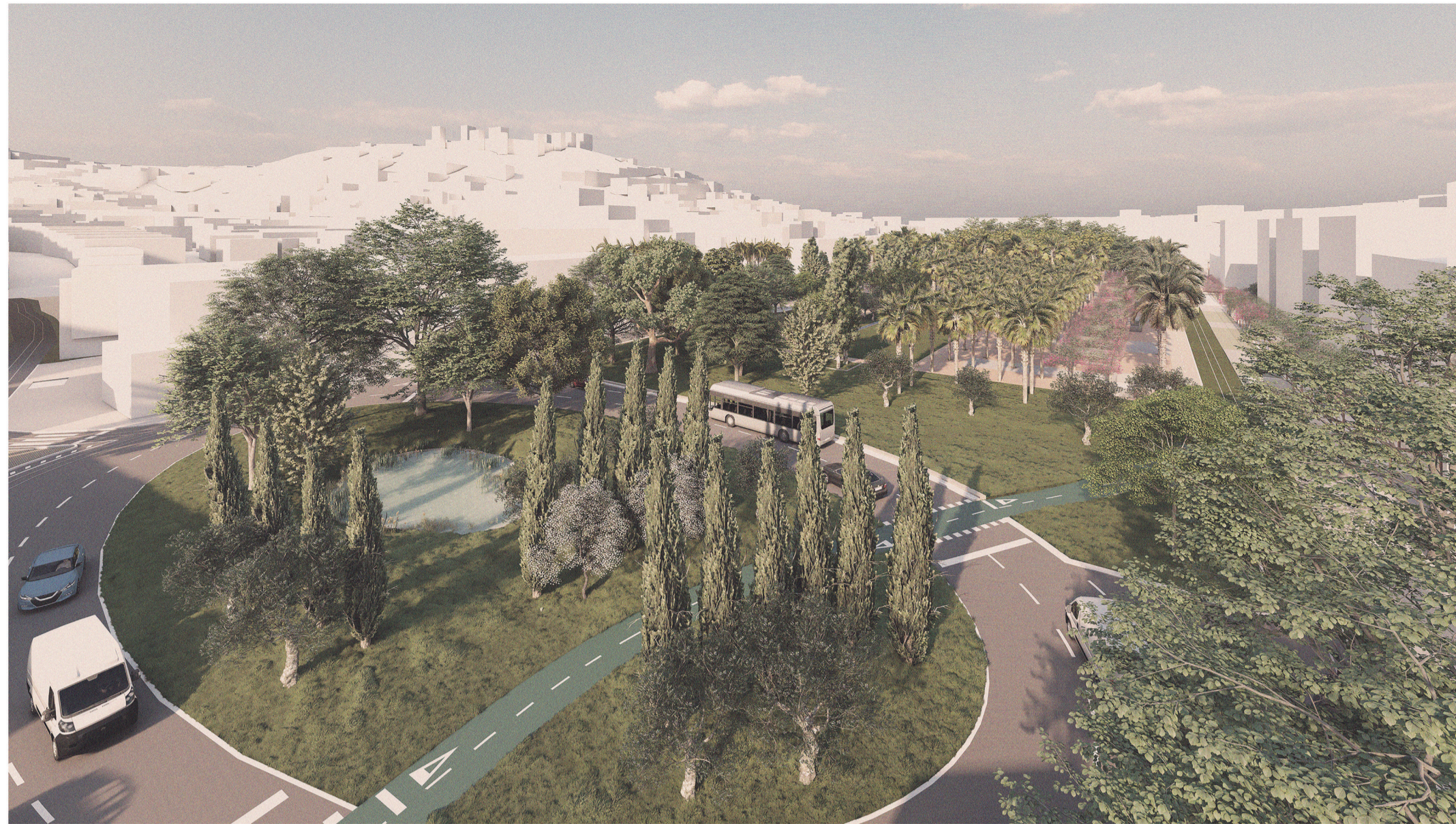
Nova rotunda - bacia de apanhamento e retenção com superfície alagada; ilustração do traçado da ciclovia neste ponto.
