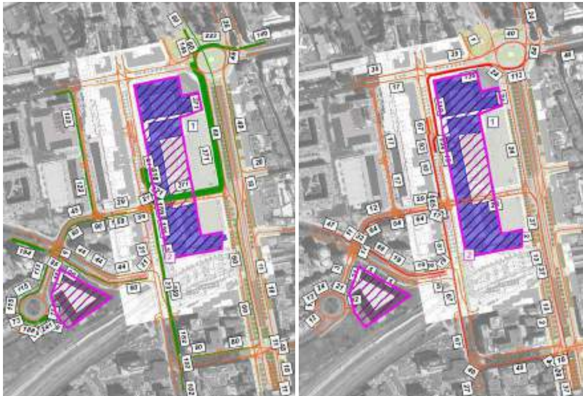
Figura 63 | Distribuição das viagens atraídas e geradas pela Operação Urbanística na HPM-DU (uvl/h) Viagens atraídas (entradas) Viagens geradas (Saídas)
