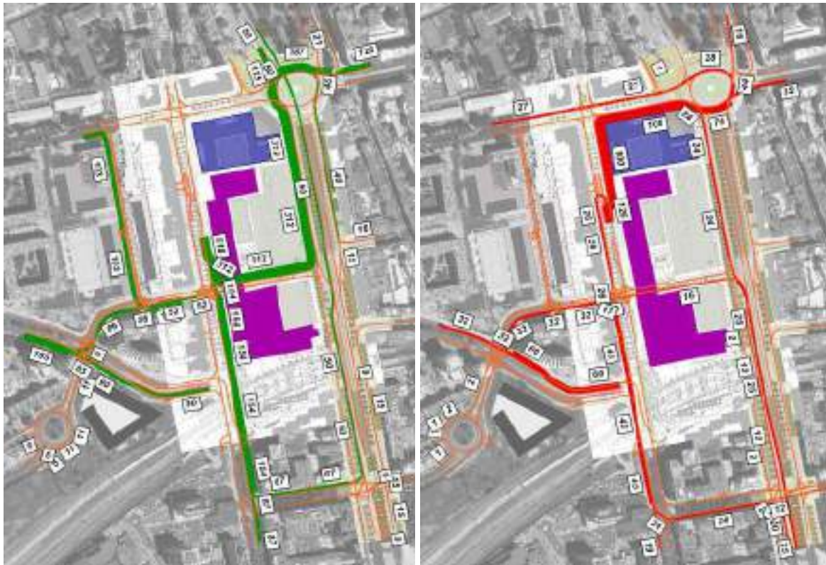
Figura 57 | Distribuição das viagens atraídas e geradas pela Parcela A + B na HPM-DU (uvt/h) Viagens atraídas (entradas) Viagens geradas (Saídas)
