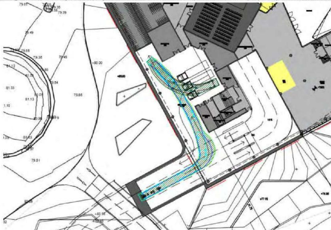
Figura 114 | verificação da circulação e estacionamento de veículos pesados no interior parque da parcela C - Saída
