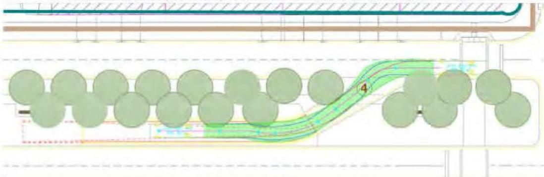
Figura 108 | Verificação da inscrição dos veículos na saída do parque - Cargas e Descargas
