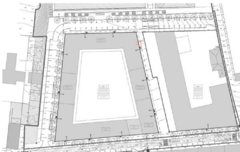
Figura 5. Peça desenhada do projeto da rede de telecomunicações.
