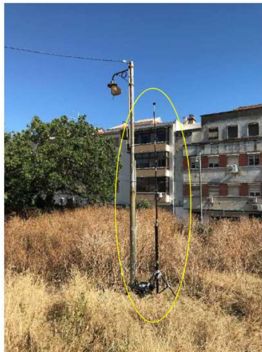
Figura 4.6 – Visualização do P2, no limite sul do loteamento (microfone instalado na ponta da vara, a cerca de 4m de altura do solo)
