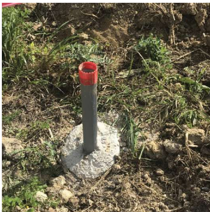
Figura 4.14 - Aspeto do piezómetro S5 Pz2
