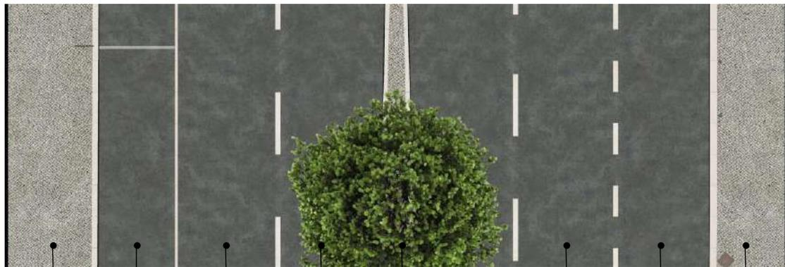
PASSEIO ESTACIONAMENTO VIA VIA SEPARADOR VIA VIA (BUS) PASSEIO
