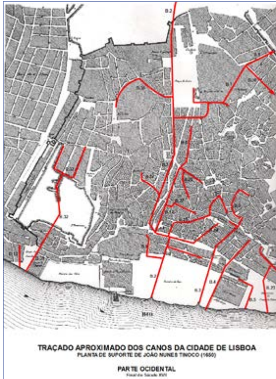
Figura 1 Traçado aproximado dos canos da cidade de Lisboa – final do século XVII – parte ocidental (planta de suporte de João Nunes Tinoco. SILVA, Augusto Vieira da – Plantas topográficas de Lisboa . Lisboa: Oficinas Gráficas da Câmara Municipal, 1950. Planta nº 1)
