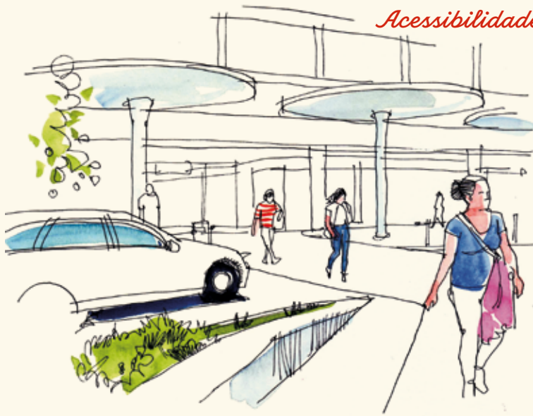
1 Piso contínuo para os peões na entrada da estação. É o automóvel que tem de vencer o desnível no pavimento, e perde prioridade.
