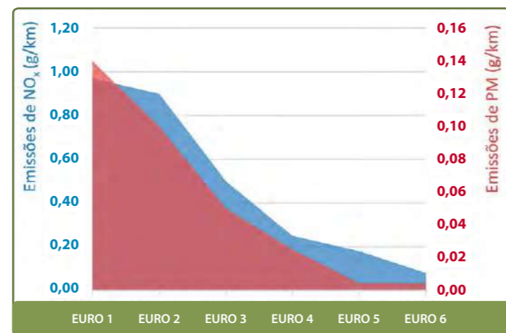
Figura 3 Exemplo da evolução das emissões, em gramas de poluente emitido por quilómetro percorrido (g/km), para veículos ligeiros de passageiros a gasóleo (Nota: emissões de NO x expressas em HC (hidrocarbonetos)+NO x )
