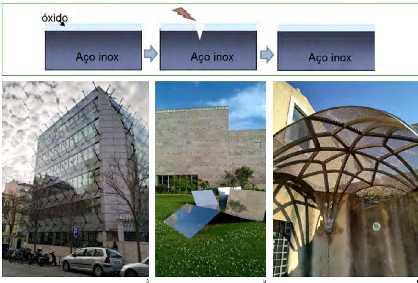
**Figura 8** Esquema do típico comportamento regenerante da camada de óxidos dos aços inoxidáveis (em cima). Exemplos de aplicações dos aços inoxidáveis em arquitetura: a. Elementos de fachada; b. Arte urbana; c. Em reabilitação de património. Fotografias da autora.
