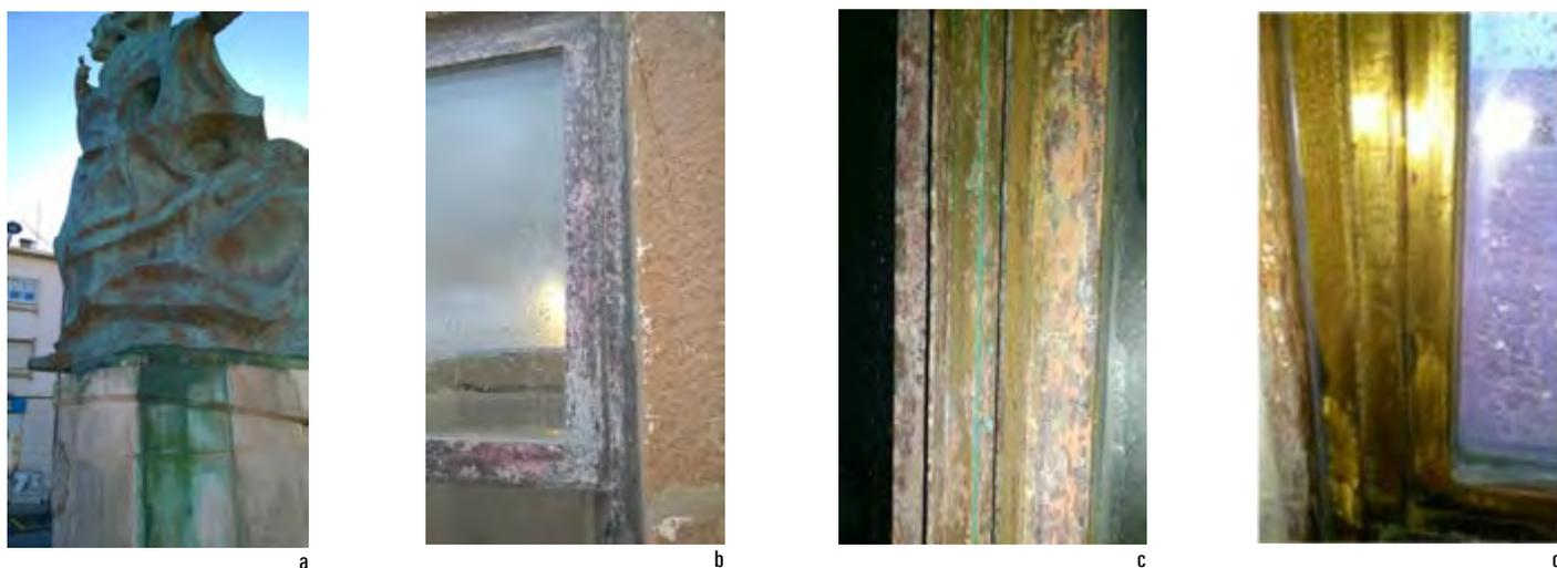
**Figura 15** Morfologia e aspeto típico das pátinas do cobre e ligas (em cima). Exemplos de formas de corrosão ativa em ligas de cobre: a. Dissolução de pátinas; b. Deszincificação em caixilharia de latão; c. Detalhe do lado exterior; d. Detalhe do lado interior. Fotografias da autora.
