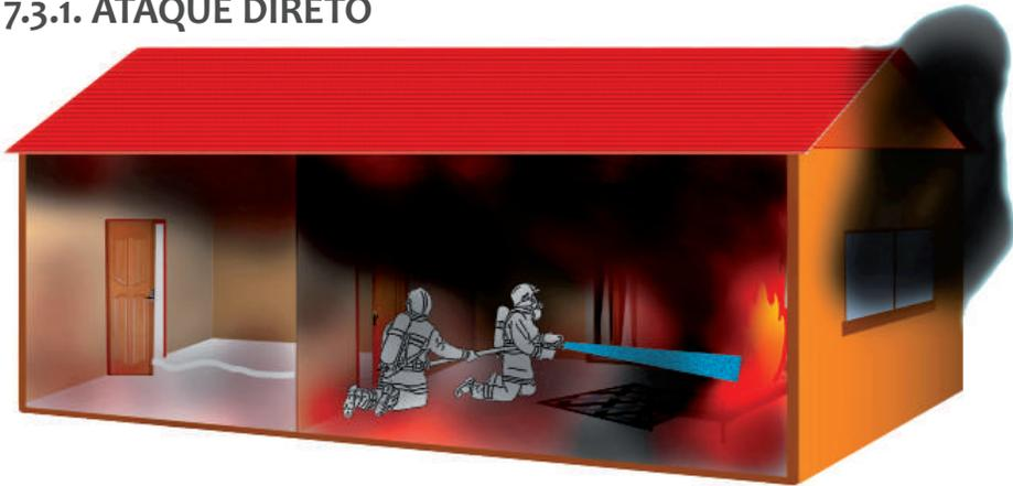
Esta técnica deve ser aplicada na fase inicial do incêndio. Projeta-se a água diretamente sobre o foco de incêndio, regulando a agulheta para um cone mínimo. O resultado obtido é a extinção do fogo.
