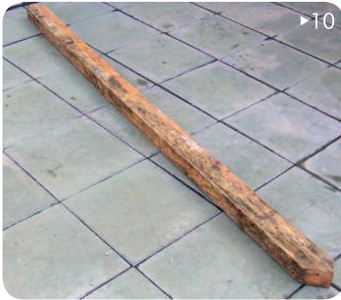
10▶ Com o auxílio de um esquadro, preparar a extremidade de modo a obter cortes idênticos aos anteriores, ficando a escora completa.
