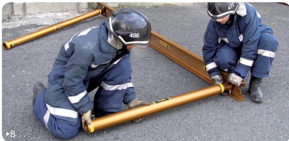
8▶ Colocar uma extensão na adaptação de união colocada no último furo.
