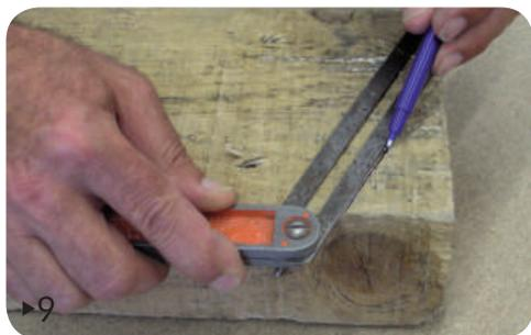
9▶ Com o auxílio de uma suta, transportar o ângulo para uma peça (viga de 8 x 16 cm) que irá servir de escora.
