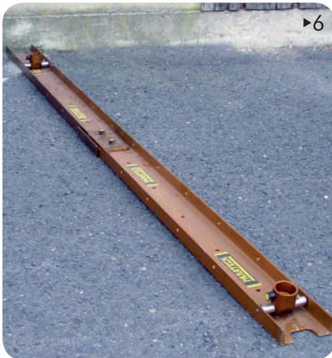
4▶ Colocar uma adaptação de união no último furo de uma extremidade de uma calha.
