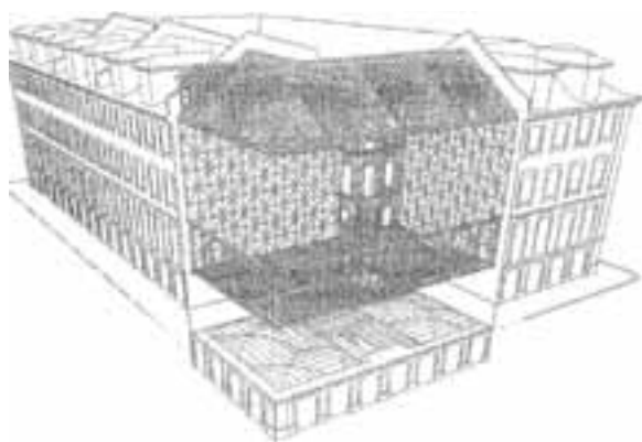
Fig. 13 – A estrutura de madeira assenta no embasamento de pedra.
