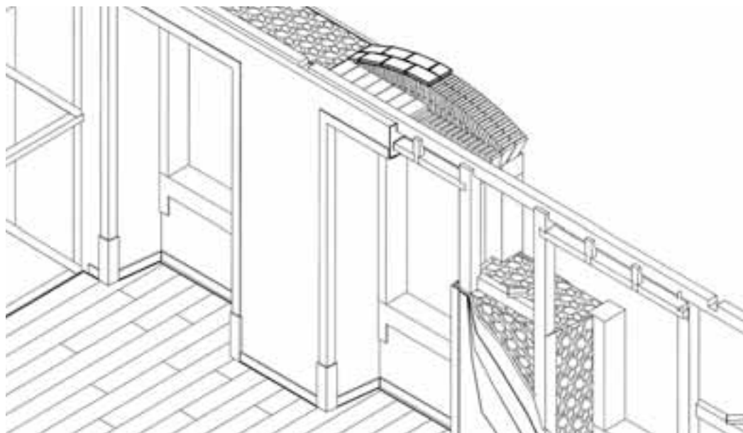
Fig. 5 – Corte perspectivado pelo interior de parede exterior.
