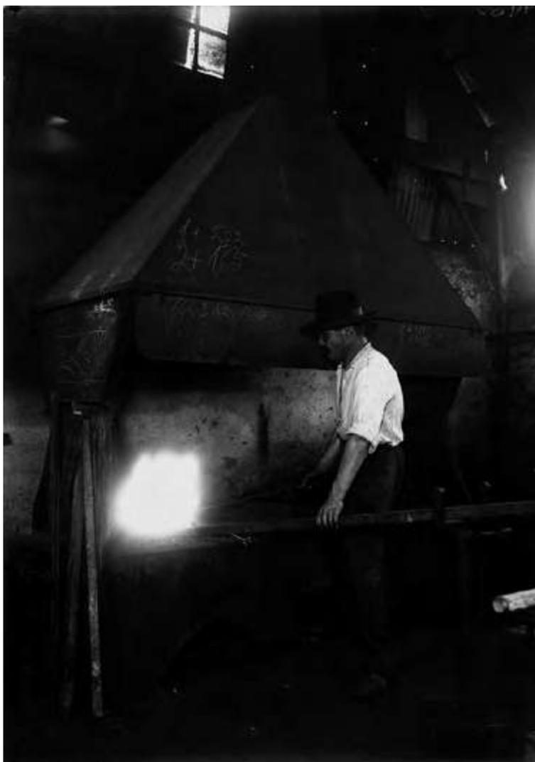
**Figura 19** Ferreiro trabalhando em forja. O trabalho de forja é tão antigo quanto a utilização do ferro e a sua operação não mudou ao longo de séculos: a fornalha e o fole no aquecimento, a bigorna e o martelo na enformação<sup>22</sup>. AML, PT/AMLSB/AMLSBAH/PCSP/004/LIM/002909.
