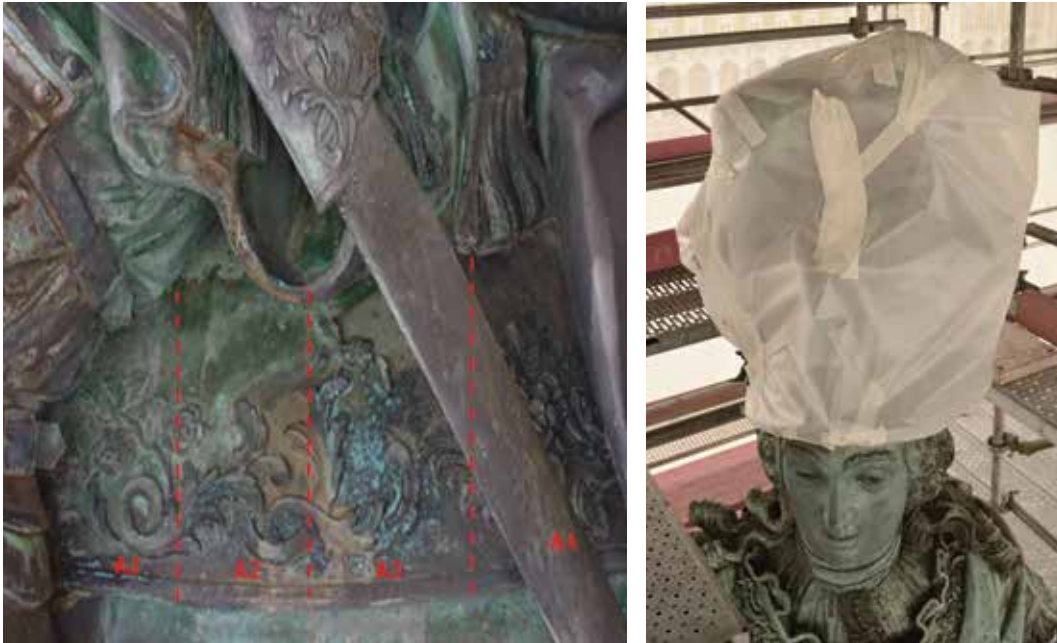
Figs. 8 e 9 – Testes de passivação química. Campânula para avaliação de pontos de corrosão activa.
