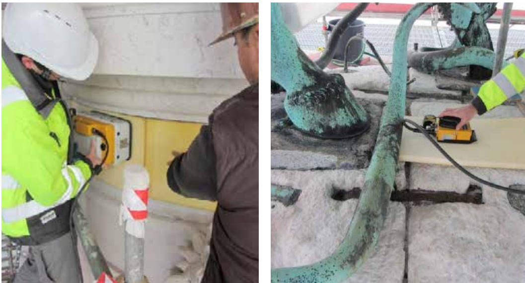
Fig. 5 - Aspectos do uso do georradar no fuste e na cobertura do pedestal. Foram usadas duas antenas com frequências diferentes para permitir atingir maior profundidade ou maior definição, conforme os casos.
