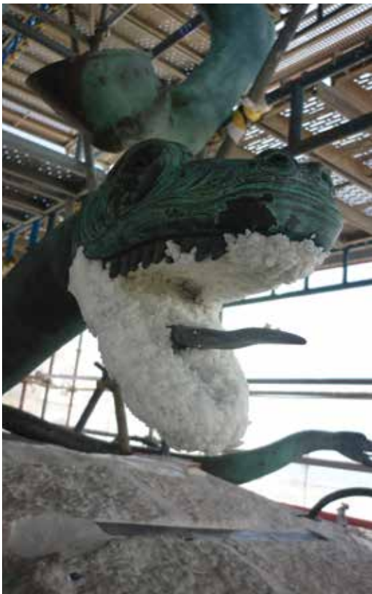
Figs.10-12 - Passivação da liga metálica com oxalato de sódio.
