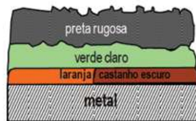
Fig. 18 – Pátina cinzenta rugosa com subcamada verde. Esquerda: aspeto visual. Direita: corte esquemático da secção transversal ilustrando as diversas camadas de produtos presentes.
