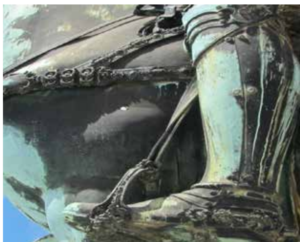
Fig. 15 – Pátina Preta. Esquerda: aspeto visual de zonas com pátina preta lisa e aderente. Direita: corte esquemático da pátina preta com subcamada laranja de cuprite.
