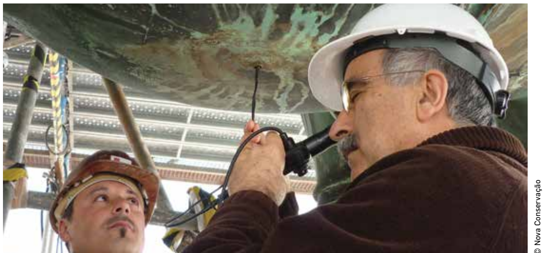
Fig. 30 – Análise por vídeo-endoscopia da estrutura interna do cavalo através do orifício de saída de águas existente no abdómen da figura.
