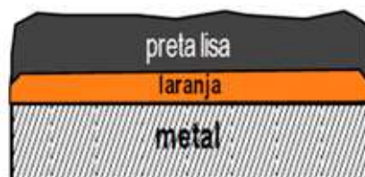
Fig. 15 – Pátina Preta. Esquerda: aspeto visual de zonas com pátina preta lisa e aderente. Direita: corte esquemático da pátina preta com subcamada laranja de cuprite.
