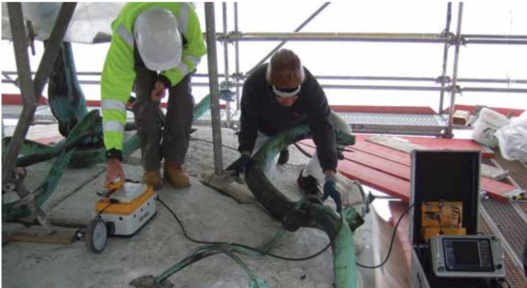
Fig.20 – Inspeção da estrutura do plinto por georadar.
