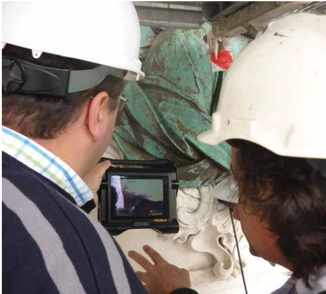
Fig. 33 – Análise por vídeo-endoscopia realizada pelo tardo do medalhão do Marquês de Pombal, para avaliação de sistemas de ancoragem e da sua condição.
