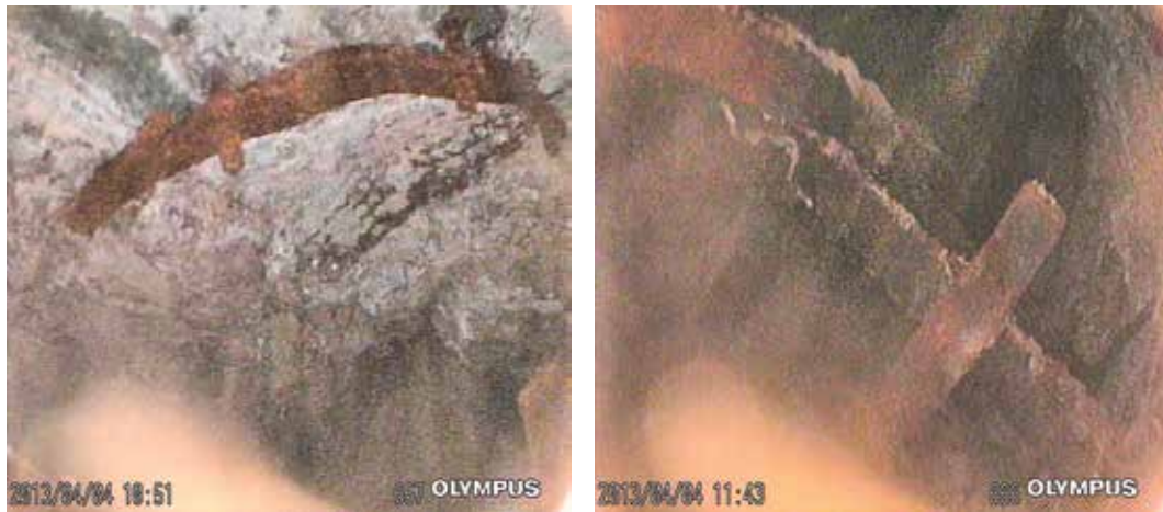
Figs. 31-32 – Imagens da estrutura interna em ferro do cavalo recolhidas por vídeo-endoscopia (barras, parafusos, zonas de ligação, invólucro em liga de cobre).
