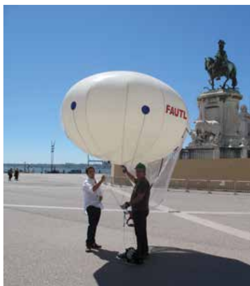
Fig. 9 – Zeppelin usado na fotografia aérea do monumento (Faculdade de Arquitectura – Universidade Técnica de Lisboa).
