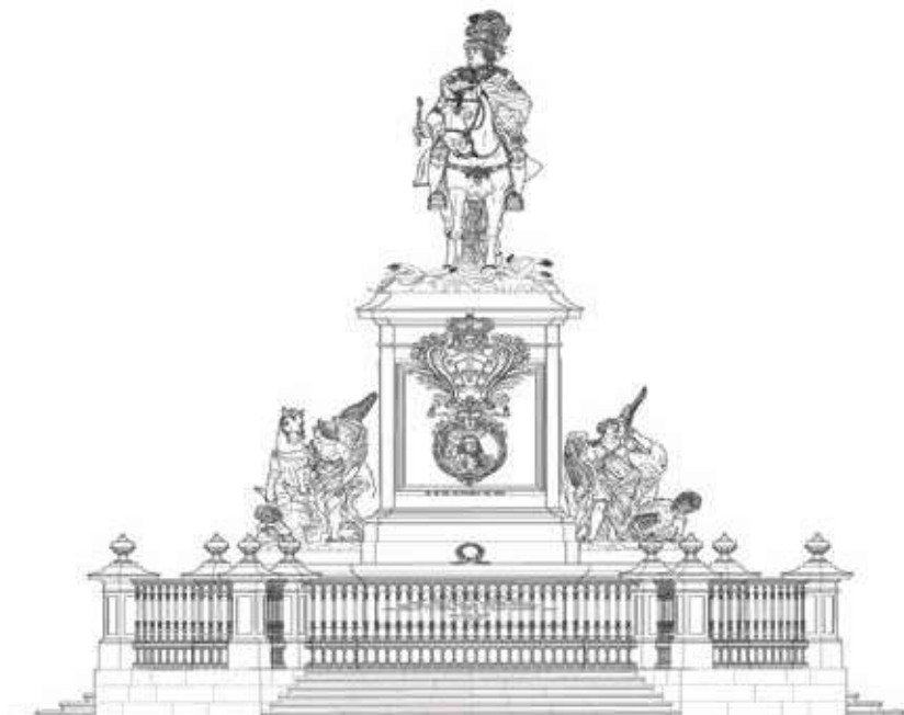
Fig.15 – Exemplo de restituição para ficheiro dwg do levantamento arquitectónico e escultórico do monumento.
