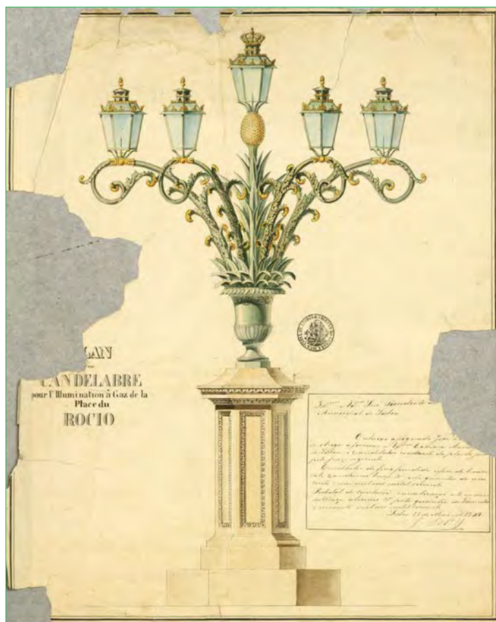
Desenho de candelabro com iluminação a gás, na praça D. Pedro IV (Rossio). Candelabro de ferro fundido, esfera de bronze, com sete candeeiros de braço, e pedestal de cantaria, adquiridos pela CML pela quantia de 50 mil réis, 22-05-1849. Arquivo Municipal de Lisboa (AML), PT/AMLSB/CMLSB/UROB-PU/11/774, p. 1.
