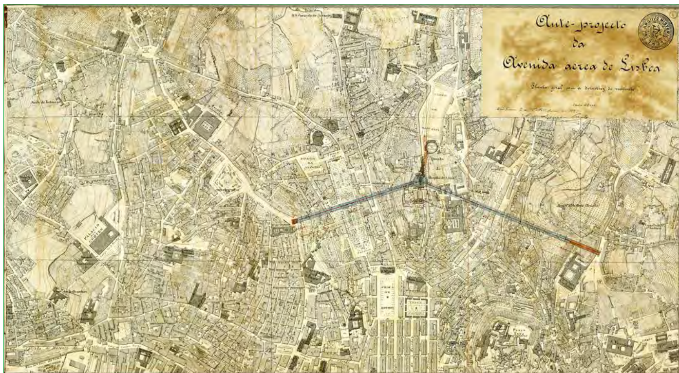
Anteprojecto da Avenida Aérea de Lisboa, um viaduto metálico a ligar São Pedro de Alcântara ao Campo dos Mártires da Pátria e, deste ponto, à Graça. Contém planta geral, alçado e perfil geral, desenho dos apoios dos arcos e pilares, resumo gráfico dos alinhamentos do projeto, caderno de encargos, memória descritiva e ofícios, 25-07-1888 – 02-09-1888.
