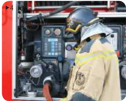
das saídas de água da bomba. Concluída a união, abre a água para a linha de alimentação, à ordem do auxiliar.
