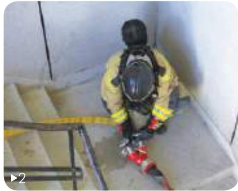
2▶ Deixa uma união no patamar, agarra a outra união e desce até ao disjuntor estendendo o lança. Efetua a união do lança ao disjuntor e verifica se as válvulas do disjuntor estão fechadas ou, se o auxiliar estiver presente, entrega-lhe a união do lança. Concluída a manobra regressa ao piso do incêndio.
