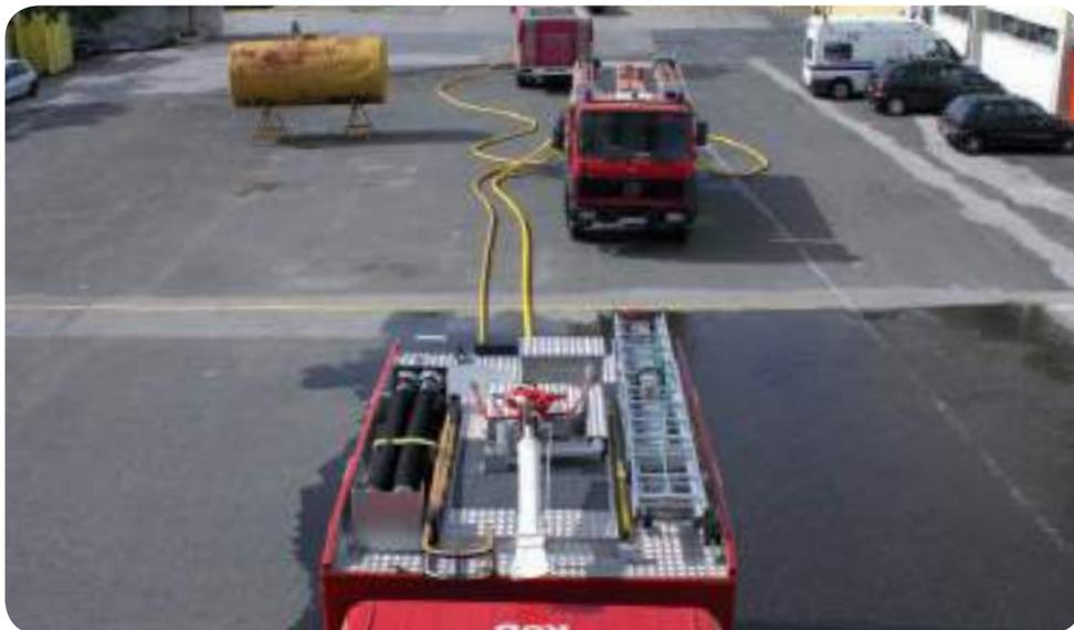
A manobra é efetuada colocando permanentemente um veículo tanque próximo do veículo a reabastecer. Outros veículos tanque, por ordem de chegada, fornecem água ao primeiro, retirando-se para se reabastecerem assim que tiver sido esgotada a quantidade de água que transportam.
