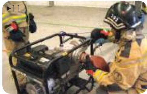
9▶ Concluída a colocação dos corpos de chupadores, o **chefe de equipa** efetua a união do primeiro corpo de chupador à entrada de água da motobomba, auxiliado pelos restantes elementos.
