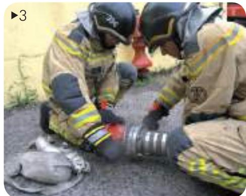
duas chaves, cavalga o segundo corpo de chupador junto das uniões dos chupadores. O **ajudante** posiciona-se atrás do chefe de equipa agarrando o ralo. O **auxiliar** e o **motorista** cavalgam o primeiro chupador, voltados para o chefe de equipa, ficando o auxiliar junto às uniões. O **chefe de equipa** e o **auxiliar** efetuam a união dos chupadores enquanto os restantes elementos auxiliam, elevando os chupadores.
