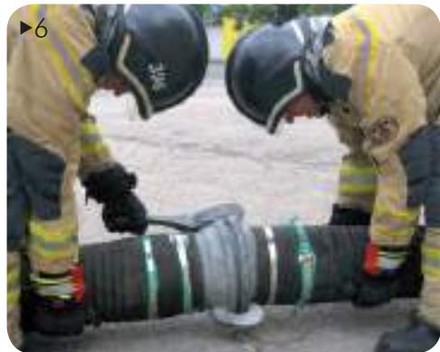
7► Concluída a união, o **motorista** efetua a ligação do primeiro corpo de chupador à entrada da motobomba, auxiliado pelos restantes elementos que, avançando para o primeiro corpo de chupador e mantendo as mesmas posições anteriores, mas agora voltados para a motobomba, elevam o chupador de modo a facilitar a união.
