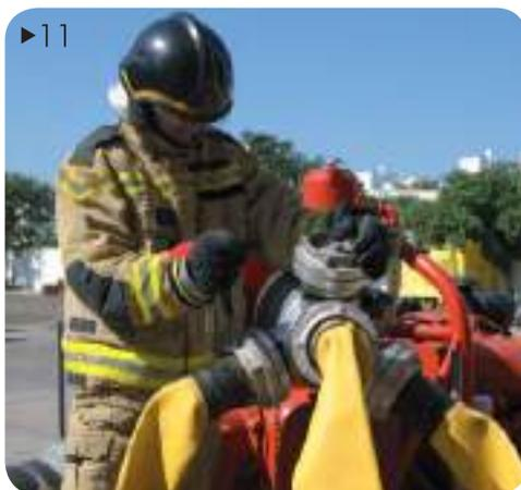
11► Após a colocação dos corpos de chupadores na água o **chefe de equipa** amarra a espia de trabalho a um ponto fixo. O **ajudante** e o **auxiliar** efetuam a união do disjuntor à saída de água da motobomba. Fazem a ligação dos lanços de mangueira ao disjuntor e orientam os lanços para o local determinado.
