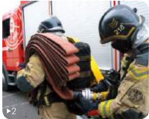
1▶ O **auxiliar** retira do veículo e coloca sobre os ombros do ajudante dois lanços de mangueira com as uniões inferiores voltadas para trás. Após a colocação dos lanços, o **auxiliar** retira as fitas de amarração dos lanços, agarra a união superior de um dos lanços e efetua a ligação com a união inferior do outro lanço. Concluído a união, retira do veículo uma chave tipo BC e um disjuntor.
