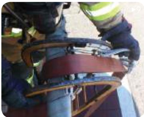
9► Quando não for necessário puxar mais mangueira, o **ajudante** coloca o francalete de gancho no primeiro lanço de mangueira e prende-o no travessão de ferro existente na volta da cabeça da escada de gancho. De seguida vai auxiliar o porta-agulheta.
