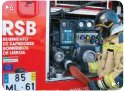
de mangueira em direção ao veículo, onde efetua a união do lança a uma das saídas de água da bomba. Concluída a união, abre a água para a linha de alimentação, à ordem do auxiliar.
