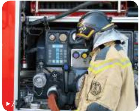
7► O **motorista**, após o ajudante colocar o primeiro francalete de gancho no lança, estende o lança de mangueira em direção ao veículo, onde efetua a união do lança a uma das saídas de água da bomba. Concluída a união, abre a água para a linha de alimentação, à ordem do auxiliar.
