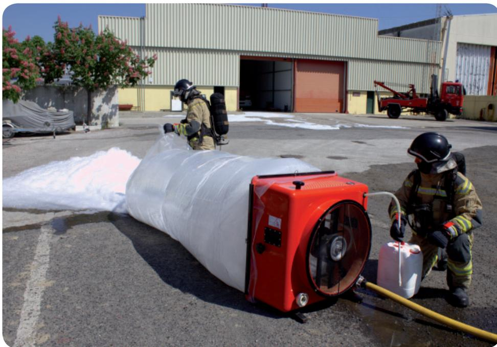
A solução espumífera é projetada sobre um grande ecrã de rede colocado perpendicularmente ao fluxo de ar, dando-se aí a formação das bolhas de espuma. Devido à sua baixa densidade a espuma produzida por este equipamento tem de ser encaminhada para o local onde é necessária através de uma manga direcional.
