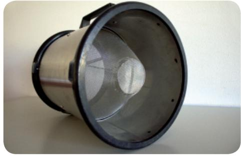
Para reforçar a mistura de ar, existe no interior do tubo que compõe o corpo da agulheta uma rede metálica ou de material sintético, que funciona como ecrã produtor de bolhas de espuma, para onde esta é projetada, arrastando atrás de si mais ar, conferindo-lhe um coeficiente de expansão superior. Esta agulheta funciona apenas com solução espumífera sintética e o alcance do seu jato é muito curto devido à baixa densidade do concentrado espumífero.
