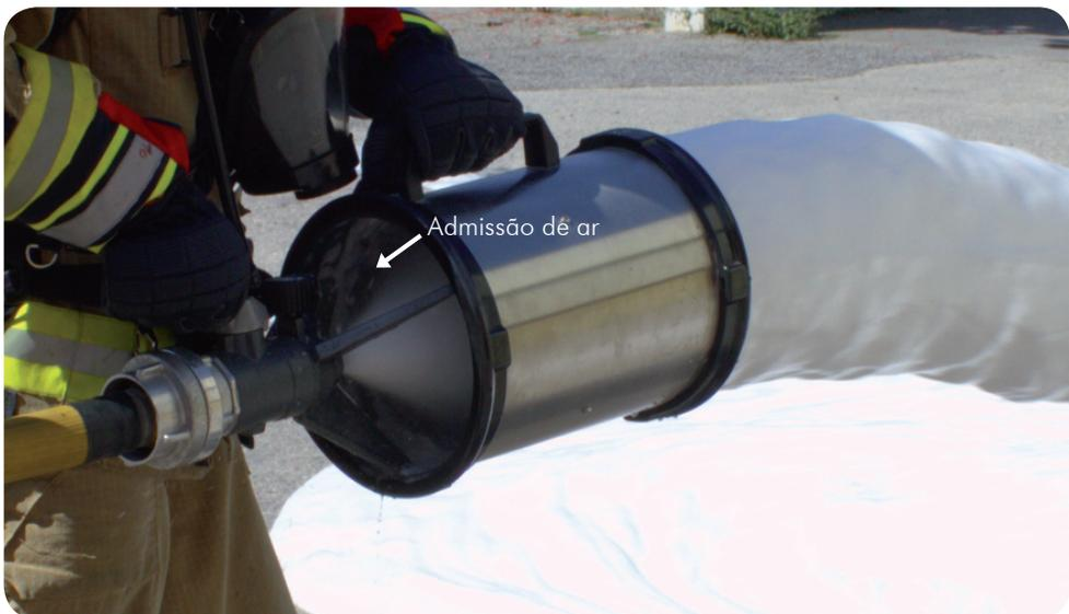
Concluída a fase de indução, a solução espumífera resultante da mistura da água com o concentrado espumífero, segue até ao equipamento gerador de espuma através de um estabelecimento de mangueiras. O equipamento gerador de espuma vai admitir ar na solução espumífera e efetua uma batida mecânica de forma a produzir espuma com o coeficiente de expansão desejado para a lançar sobre o incêndio.
