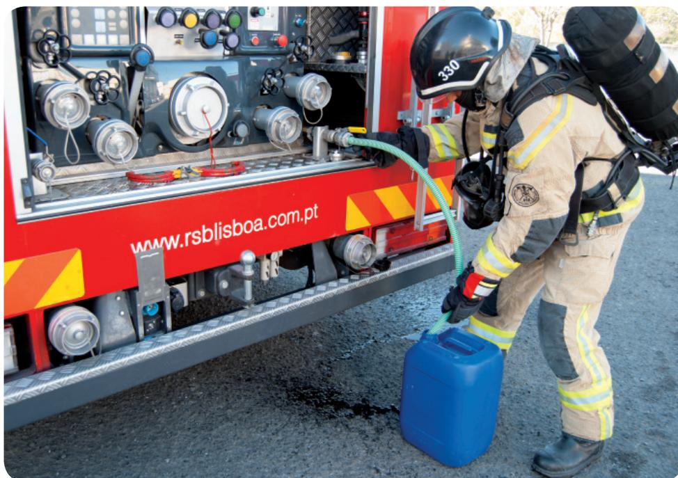
Este equipamento montado em veículos de combate a incêndio é capaz de operar com débitos compreendidos entre os 200 e os 2000 litros/min. Tem como único inconveniente o facto de toda a água que sai da bomba ir com concentrado espumífero misturado, o que obriga a utilizar outro veículo quando é necessário efetuar proteção de exposições.
