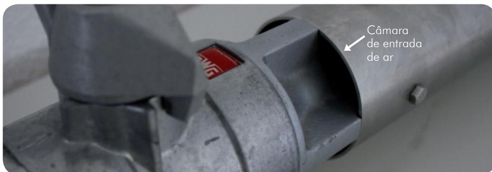
Deste processo de admissão de ar, da redução da velocidade da água pelo – princípio de Venturi, acrescida da perda de energia devido à batida mecânica e associada à baixa densidade da espuma, resulta que o alcance do jato produzido por esta agulheta seja muito menor que os das agulhetas convencionais de combate a incêndios.
